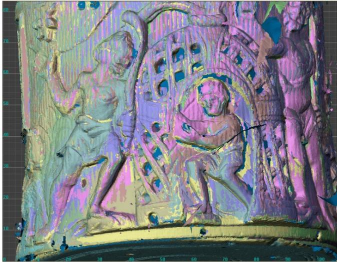
*Punktwolke aus (farbcodierten) Teilscans nach Registrierung mittels ICP-Algorithmus*
