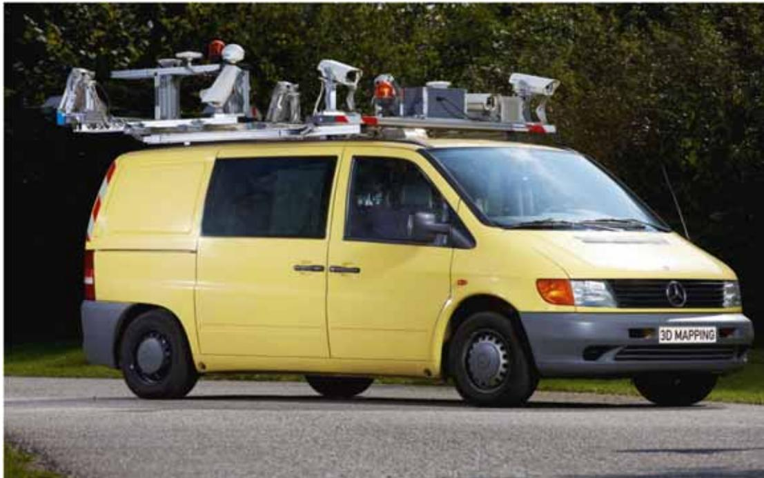
8 Kameras, 2 Standard- und bis zu 4 Hochleistungs-Laserscanner
