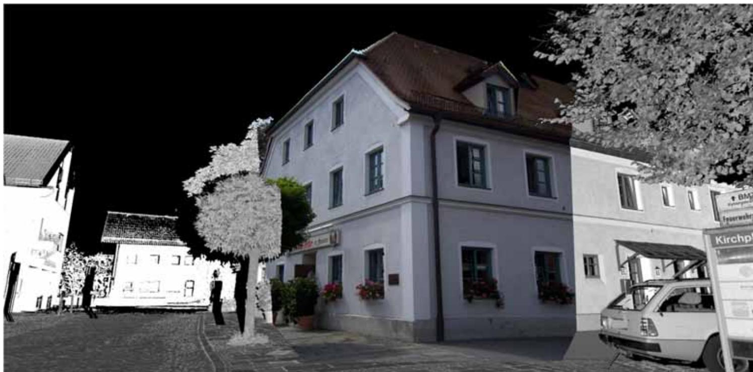
Kinematisch erfasste Laserscanner-Punktwolke mit überlagertem Farbbild
