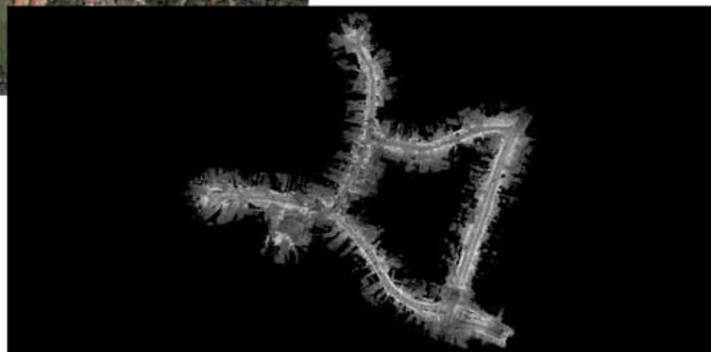
Kinematisch erfasste Laserscanner-Punktwolke
